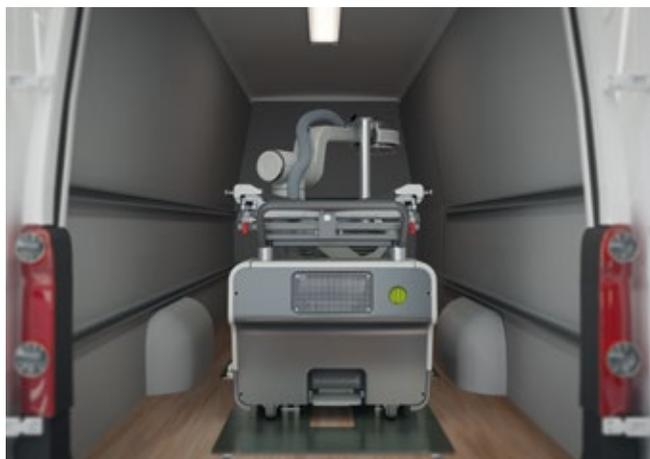
Транспортная плита с фиксатором колеса
